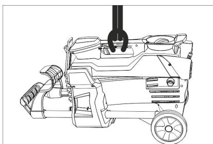
➔ Pie aparāta nešanai paredzētā roktura piestipriniet celšanas iekārtu.
